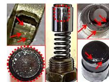
Engripamento da válvula de segurança limitadora da pressão de óleo (válvula de alívio).
